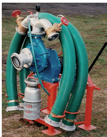
Fotografia 8. Ciągnikowy agregat pompowy (źródło: Łukomet)
