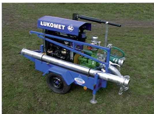
Fotografia 7. Spalinowy agregat pompowy (źródło: Łukomet)
