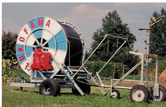
Fotografia 11a. Deszczownia szpulowa zakończona zraszaczem (źródło: Łukomet)
