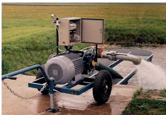
Fotografia 6. Elektryczny agregat pompowy (źródło: Łukomet)
