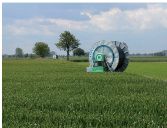
Fotografia 11b. Deszczownia szpulowa (źródło: R. Rolbiecki)
