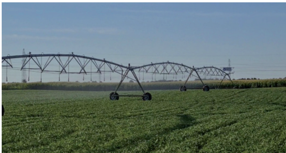
Fotografia 15a. Deszczownia mostowa w czasie pracy (źródło: R. Rolbiecki)
