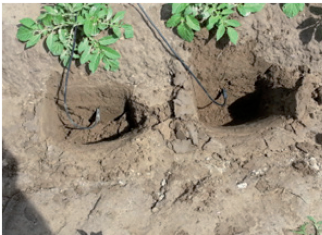
Fotografia 3. Czujniki zainstalowane na stałe w strefie korzeniowej ziemniaka (fot. R. Wawer)
