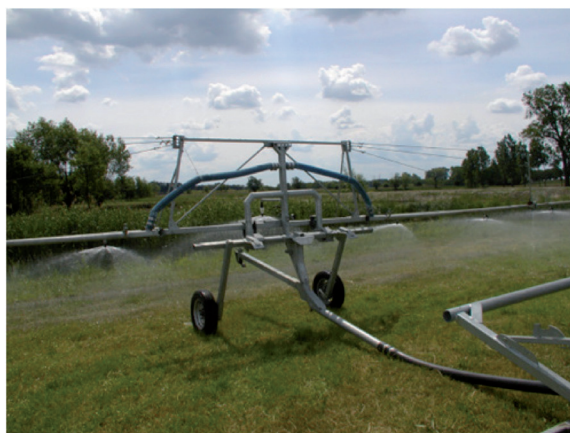
Fotografia 13. Deszczownia szpulowa zakończona konsolą w czasie pracy (źródło: R. Rolbiecki)
