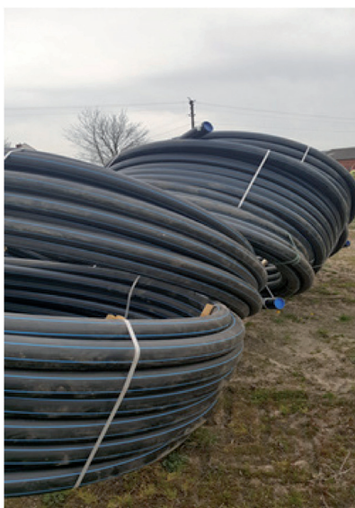
Fotografia 9. Deszczowniane węże przesyłowe PE (źródło: R. Rolbiecki)
