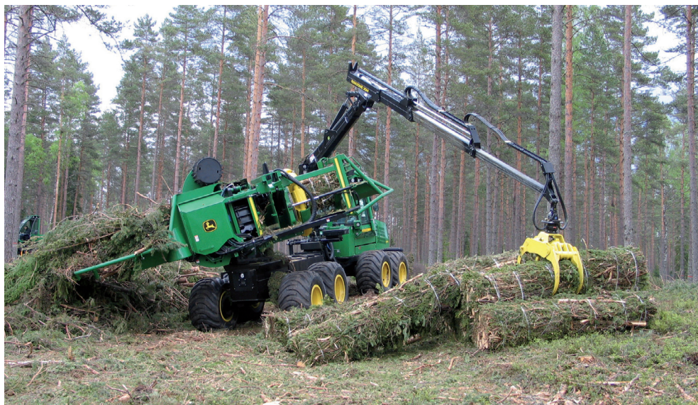
FOT. 2. Balociarka do pozostałości pozrębowych firmy John Deere zamontowana na podwoziu forwardera
