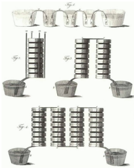
W roku 1800 skonstruował ogniwo Volty poprzez zanurzenie płytek srebra i cynku w słonej wodzie i przeprowadził eksperyment elektrostymulacji drogi słuchowej
