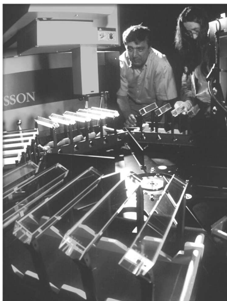
Rys. 7. Sprawdzanie jakości kryształów wolframianu ołowiu na automatycznej stacji pomiarowej w CERN-ie. Kryształy pochodzą ze specjalnej linii produkcyjnej zbudowanej dla potrzeb CMS w zakładach w Bogorodzicku (Rosja)
